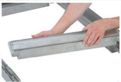
Odstranění mezilehlého mostu
